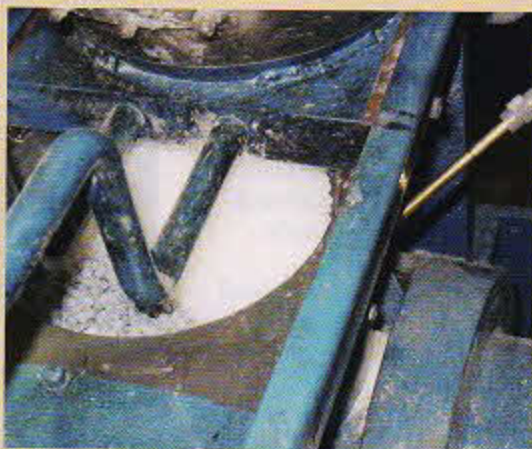
Die Messinglanze mit Farbzuführung über einen Schlauch sitzt direkt an der Materialzuführung und wird bei Farbwechseln komplett gewechselt, sodass die Farbe im geschlossenen System verbleibt
