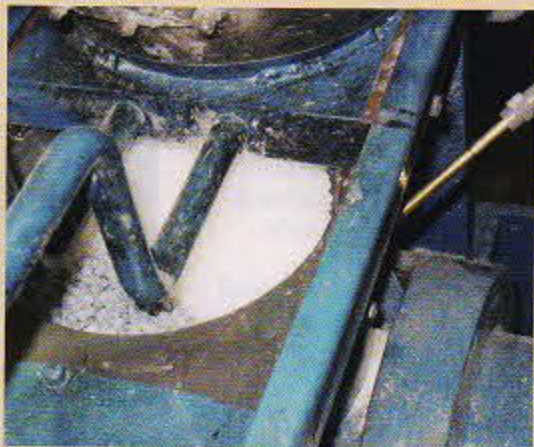
Die Messinglanze mit Farbzuführung über einen Schlauch sitzt direkt an der Materialzuführung und wird bei Farbwechseln komplett gewechselt, sodass die Farbe im geschlossenen System verbleibt
